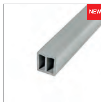
Einbetonierhilfe Kunststoff, BxH: 21.5 x 22 mm, für Putzdecke, leicht konisch für eine einfachere und schnellere Ausschalung
